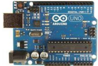
Figure 28: Microcontrôleur Arduino
